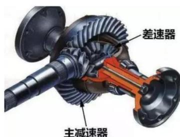
主减齿轮（主减速器）通常与差速器总成配合使用，基本功用是将来自变速器或者万向传动装置的转矩增大，同时降低转速并改变转矩的传递方向。
